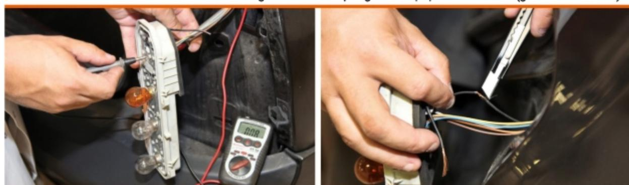
**4 Trouvez le fil de masse du faisceau.** A l'aide d'un ohmmètre branché entre la platine et la caisse (tôle ou vis), ou en suivant le cheminement du circuit, repérez le fil de masse (noir en général). Dénudez-le sur 1 cm.
