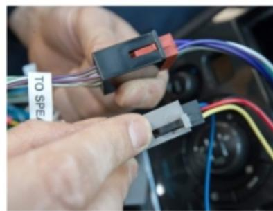
**2 Branchez le Y du kit.** Placez-le entre le faisceau (via un adaptateur ou en direct) et la radio. Avec un poste à prise FAKRA (voir ci-dessus), il faut un second Y.
