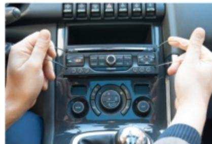
**1 Déverrouillez la radio.** Glissez les "U" dans les encoches aux quatre coins et poussez-les vers l'extérieur pour extraire le poste. Ces encoches sont parfois derrière la façade.
