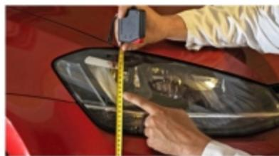
**1 Placez l'auto à 10 m du mur.** Vérifiez la pression des pneus puis, sur sol plat, mesurez la distance sol-axe de l'ampoule (ici, 67 cm).
