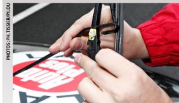
**1** **Pivotez le clip.** Cela libère le petit trou dans l'armature pour insérer le crochet du bras.
