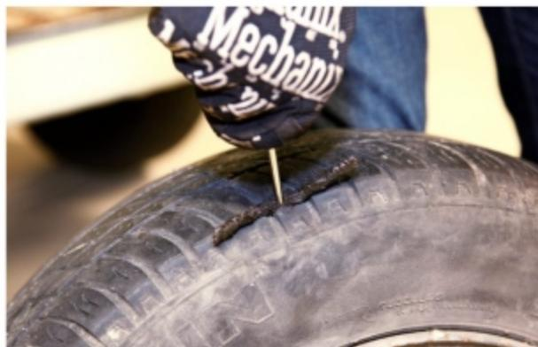
**3 Colmatez.** Retirez la lime et enfoncez la mèche, insérée dès le début dans le chas du poinçon, jusqu'à transpercer le pneu. Tournez la poignée du poinçon d'un quart de tour pour libérer la mèche, et retirez-le doucement.
