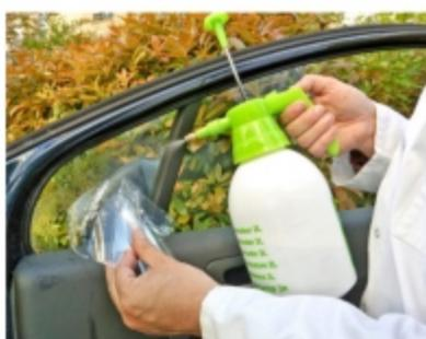
**2 Mouillez vitre et film.** Vaporisez généreusement d'eau légèrement savonneuse. Puis positionnez le film sur le verre.
