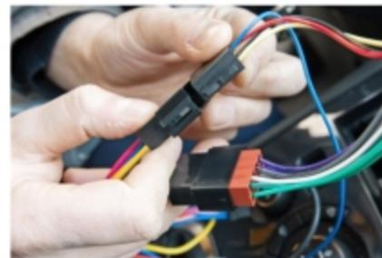
**3 Branchez l'adaptateur.** Connectez-le au faisceau du poste (noir pour l'alimentation, marron pour les HP). Munies de détrompeurs, les prises ne peuvent être inversées.
