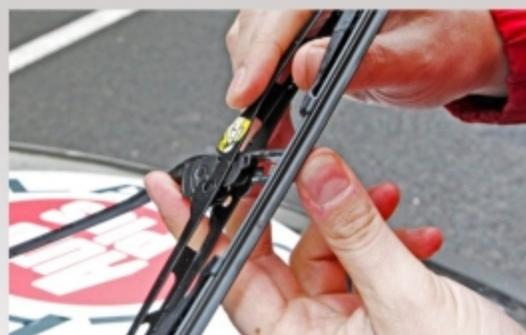
**2** **Alignez le clip.** Tournez-le sur l'armature pour le placer dans l'alignement du crochet.
