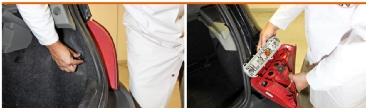
**1 Déposez le bloc de feux.** Dévissez l'écrou ou le papillon situé à l'intérieur du coffre (voir la marche à suivre dans votre livret utilisateur). Puis déclipsez la platine porte-ampoules en laissant le connecteur branché.
