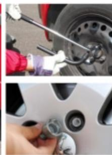
**1 Accédez aux écrous de roue.** Pour atteindre les écrous, tirez fermement sur l'enjoliveur (veillez à place l'encoche en face de la valve au remontage!). Sur jante alu, retirez les caches des écrous à l'aide de la pince spécifique. Puis sortez la clé pour débloquer les écrous.
