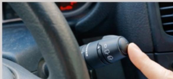
**1** Contact mis, faites défiler les informations de l'afficheur à l'aide du poussoir placé au bout de la commande d'essuie-glaces, jusqu'à ce que l'échéance d'entretien s'affiche, puis...
