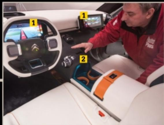
► **Du numérique en haute définition.** Double écran 12" 1, dont un est réservé au passager. Celui-ci, motorisé, peut coulisser et s'accoler à celui du conducteur (instrumentation et GPS). Il suffit pour cela d'un simple geste de la main au-dessus d'un capteur sur la console 2.
