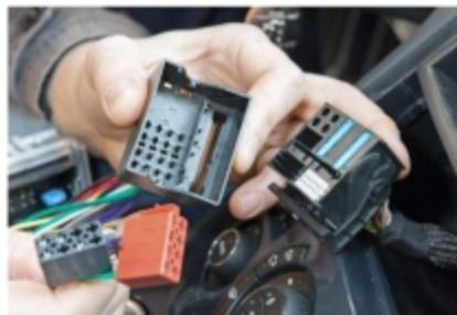
**2 Changez de norme.** Afin de passer la connectique de la norme FAKRA (en haut) à l'ISO, intercalez un faisceau adaptateur (30 €) entre celui de l'auto et votre nouvelle radio.
