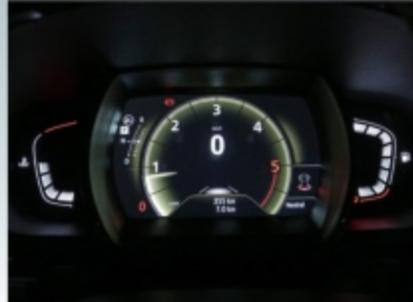
L'instrumentation entièrement digitale est lisible. Présentation et couleurs changent en fonction des modes de conduite sélectionnés (Eco, Sport, Confort...). Les lumières d'ambiance sont alors assorties.
