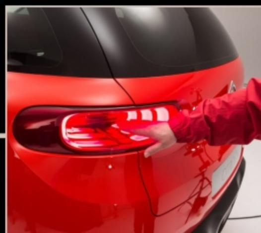
► **Des feux AR super design.** Les optiques à effet 3D ont de plus en plus la cote. Ici, la signature est spécifique, avec un feu rempli de barres de leds comme un puits de lumière.
