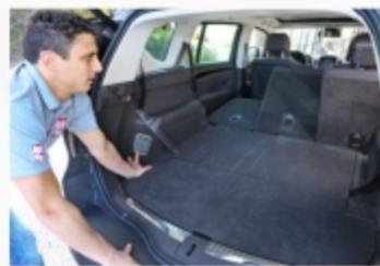
Non seulement les sièges se plaquent en formant un plancher plat, mais, en plus, l'opération se fait électriquement depuis le coffre ou la tablette tactile. Bravo!
