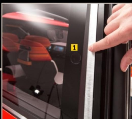
► **Des caméra dans les vitres.** Une "webcam" cachée derrière les vitres arrière 1 permet de filmer le paysage. Ceci permettrait, par exemple, d'identifier, via internet, les monuments sur la route.
