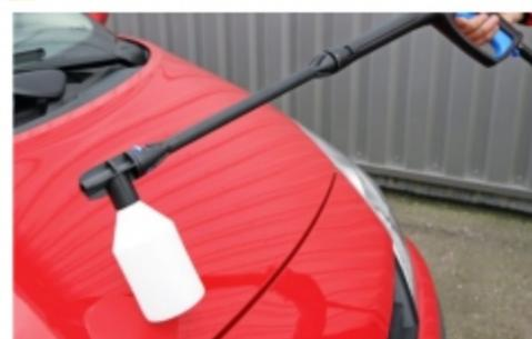
**1 Le diffuseur de mousse.** Il est à remplir de nettoyant multi-usage. Il se visse au bout de la lance. On peut ainsi rapidement "couvrir" l'auto.
