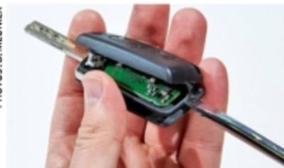
**1 Ouvrez la coque usagée,** afin de récupérer le circuit électronique et la pile (profitez-en éventuellement pour la remplacer!). Redisposez-les de la même manière à l'intérieur du nouveau boîtier.
