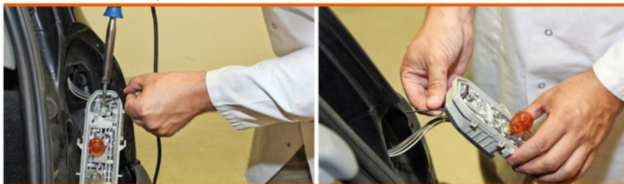
**3 Soudez un fil sur la plaque de masse.** Dénudez un fil de 10 cm de long et, à l'aide d'un fer à souder et d'étain, fixez-le sur la tôle de la plaque. Passez le fil à travers la platine, afin qu'il ressorte vers le connecteur.
