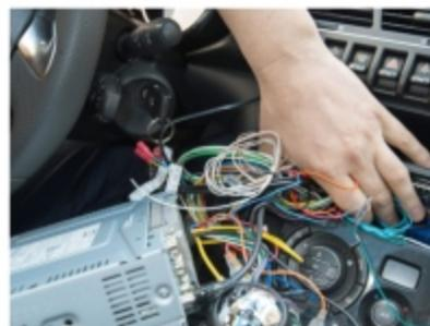
**4 Rangez la masse de fils.** Utilisez des brides au besoin et glissez le boîtier du kit mains libres au fond du logement, en douceur afin de ne rien débrancher.
